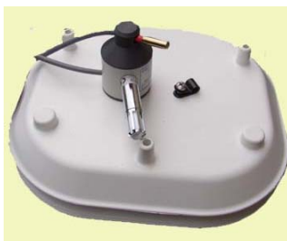
EIT relative humidity sensor mounted in EIT radiation shield
